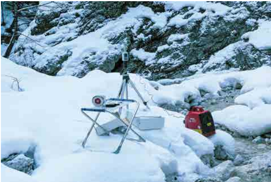
Februarsko vzorčenje zraka pri Paraboli. Pomagali smo si tudi z bencinskim generatorjem za polnjenje baterij vzorčevalnika zraka.
