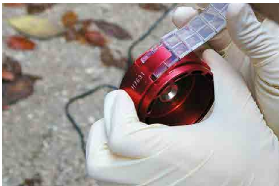
V rdeči vrtljivi bobni, ki se z magnetom pritrdi na vzorčevalnik zraka RCS High Flow, se na terenu vstavi plastični nosilec gojišča za bakterije, na katerem je medij za vzorčenje.
