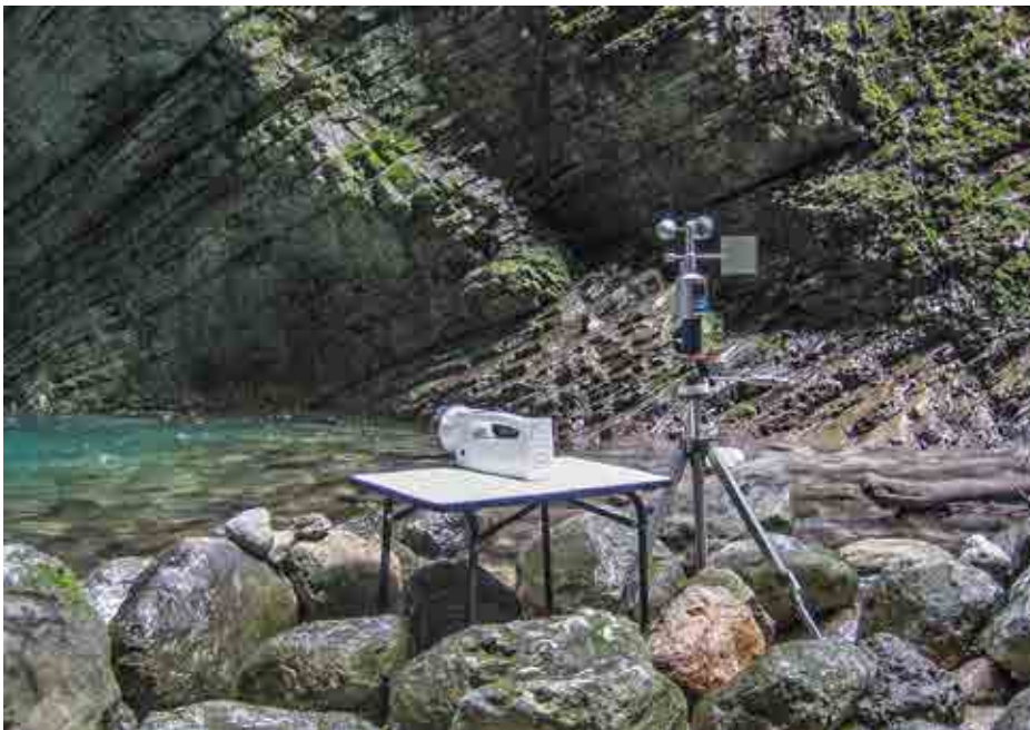
Vzorčenje zraka z napravo RCS High flow in merjenje atmosferskih parametrov z meteorološko postajo pri slapu Kozjak.
